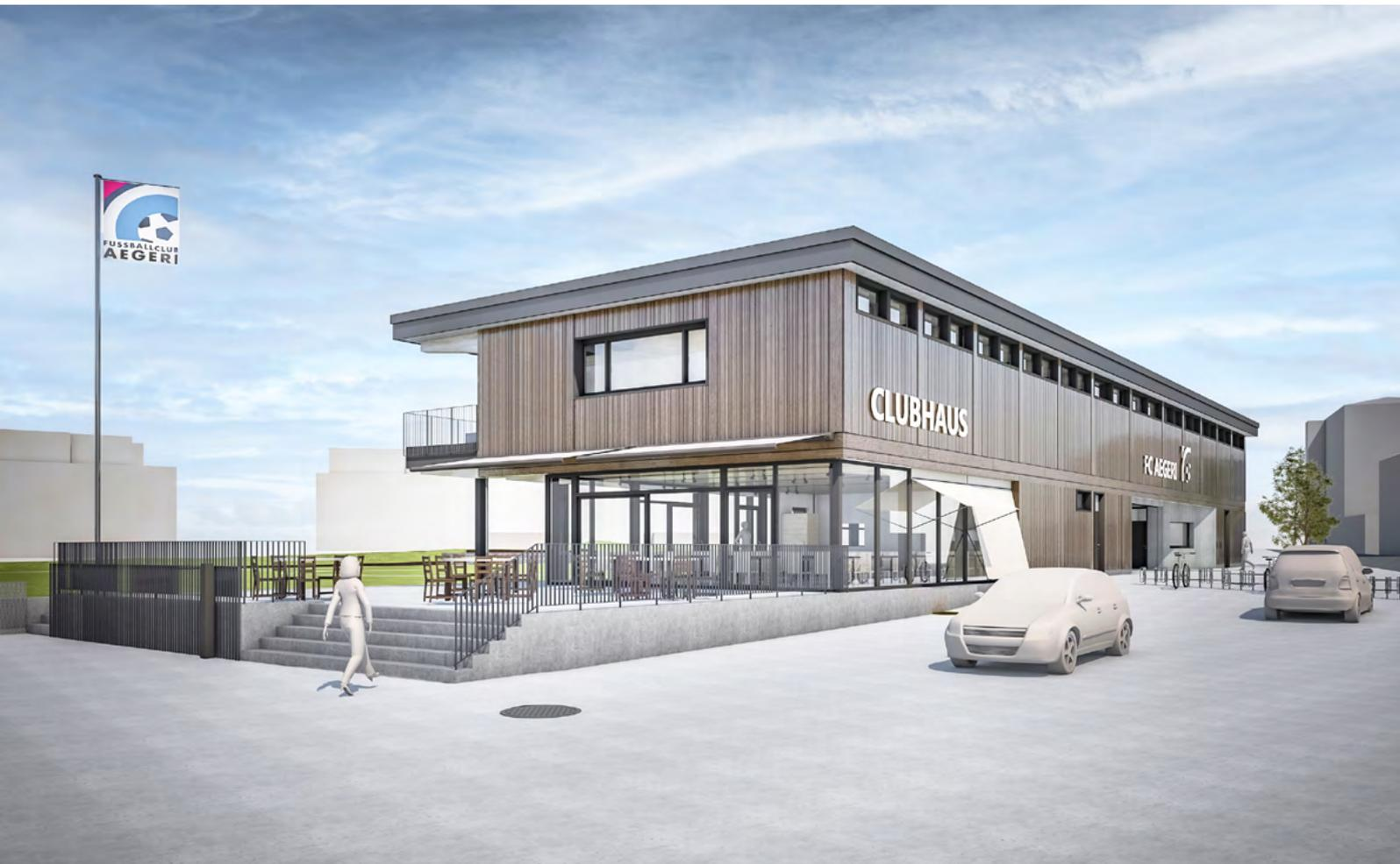
Die Fassade wird mit einer strukturierten, vertikal verlaufenden, attraktiven Holzschalung erstellt, welche die Raumaufteilung im Innern widerspiegelt und das lange Gebäude horizontal und vertikal unterteilt. Das Gebäude steht auf einer Bodenplatte aus Beton, und der Hauptzugang wird mit Sichtbeton erstellt. Die übrige Tragstruktur mit Aussen- und Innenwänden, Decken und Dächern sind aus Holz.
