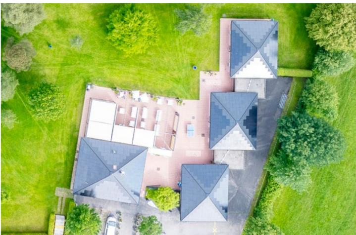
Die Dächer der vier Gebäude im Strandbad Lido mussten saniert werden. Dabei nutzte die Gemeinde die Gelegenheit, eine nachhaltige Lösung zu implementieren. So wurde eine moderne Indach-Photovoltaikanlage eines Schweizer Solarpanel-Herstellers installiert.
