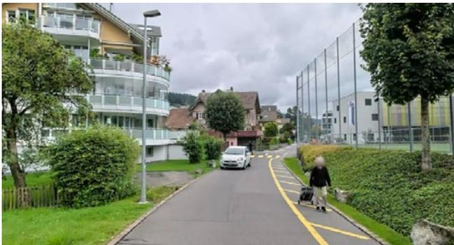
Abb. 11: Bühlstrasse West mit markierter Fussverkehrsinfrastruktur (Längsstreifen für Fussgänger)
